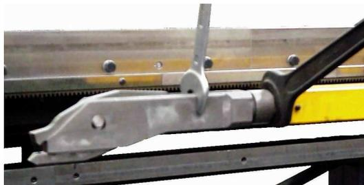
Quando la pinza è in posizione orizzontale per afferrare il profilo sull'ala, è necessario porre attenzione all'altezza del punto di presa in quanto la pinza deve passare nella fessura predisposta sulla morsa dell'unità di foratura e dell'unità di taglio sul filo fisso.
