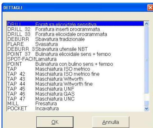
Le voci di sinistra “DRILL”, “DRILL 32”, ecc... sono codici che definiscono il tipo di utensile per il software del C.N.; l'operatore può selezionare tramite frecce su tastiera PC o touch screen l'utensile voluto e attivare “OK” per selezionare il tipo di utensile.
