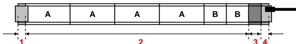
Dislocazione della zona 3 (sfrido materiale) e tipo di pezzi cumulabili in una barra possono essere generati automaticamente dal software del C.N. o realizzati/modificati dall'operatore.
