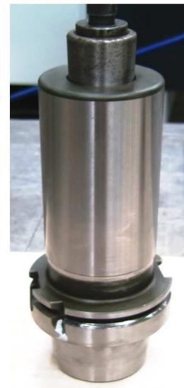
Ambedue i tipi di portautensili presentano due cave di medesima larghezza e di differente profondità; il cono deve essere inserito nel magazzino in modo tale che la cava meno profonda coincida con la chiavetta di riferimento (se presente) di ogni locazione del magazzino.
